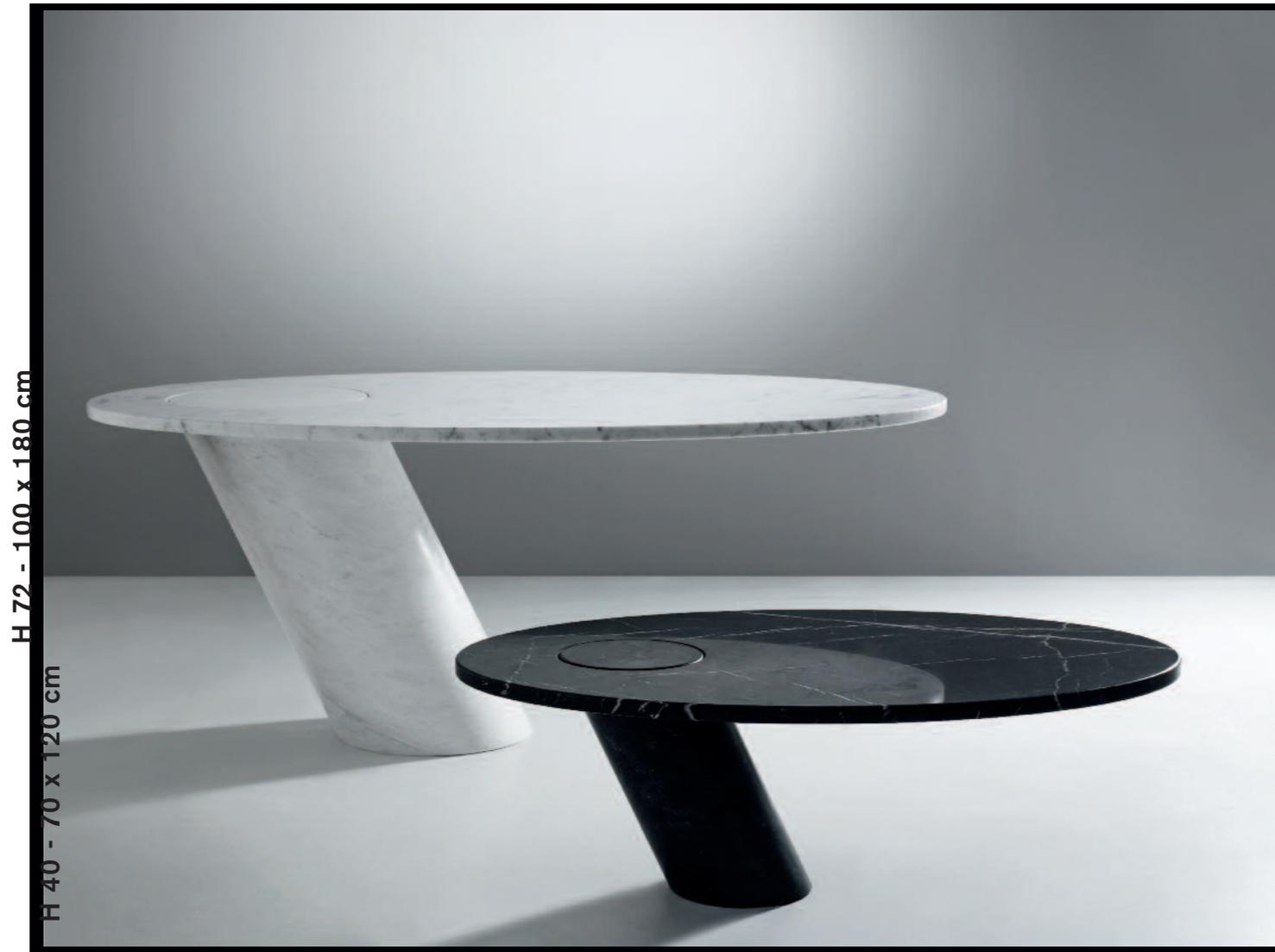
Ancora un tavolo interamente in marmo che continua la ricerca sui giunti a gravità: in questo caso la particolare soluzione del piano ellittico, inserito in modo asimmetrico in una gamba cilindrica inclinata, blocca per attrito ed eccentricità lo scorrimento verticale, schiacciando e rendendo con il proprio peso il giunto altrimenti aperto un incastro chiuso a tutti gli effetti.
