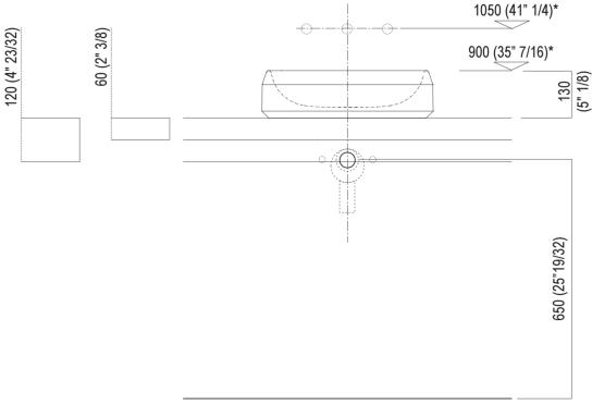
Scarico per sifone ad incasso Drain for concealed waste trap
