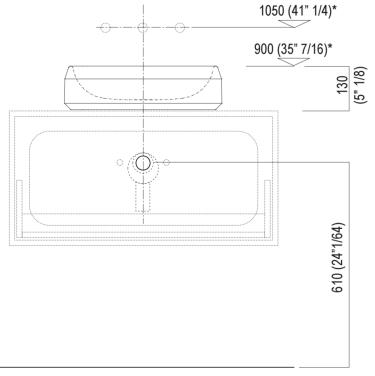
Scarico per sifone a bottiglia o ad incasso Drain for bottle trap or concealed waste trap
